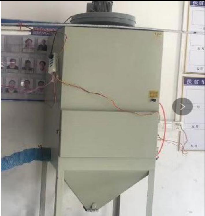
图 3.1.2-2 粉尘收集措施现场照片
